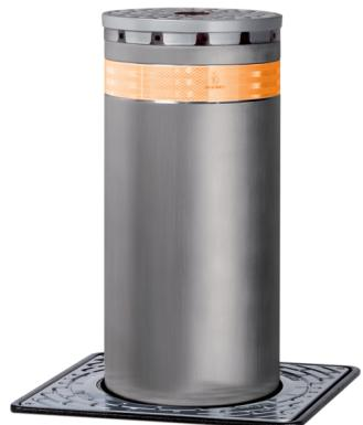
مناسب کنترل تردد با قابلیت تراویکی و امنیتی ارتفاع بولارد ۸۰ سانتی متر، قطر ۲۷/۵ سانتی متر و ضخامت بدنه بولارد ۶ میلی متر بدنه از جنس استیل ضد زنگ مجهز به دو عدد لوپ دیتکتور مجهز به چراغ چشمک زن LED و بیزر (صدای هشدار دهنده) در زمان حرکت پرساخت و بی صدا در حرکت تعداد تردد نامحدود بی نیاز از سرویس و نگهداری Ip67
